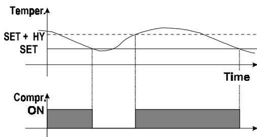
Bei Fühlerfehler wird automatisch ein Verdichter-Zyklusbetrieb gestartet. Parameter "CON" (Einschaltdauer) und "COF" (Ausschaltdauer).
